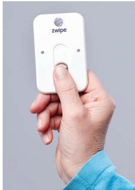
Принцип работы карты Zwipe следующий: пользователь прикладывает заранее внесенный в память палец к сканеру, который активирует соответствующий встроенный в карту транспондер (непосредственно бесконтактную составляющую), и предъявляет последнюю считывателю. Обмен данными между картой и считывателем возможен только тогда, когда отпечаток пальца пользователя совпадает с записанным шаблоном.
