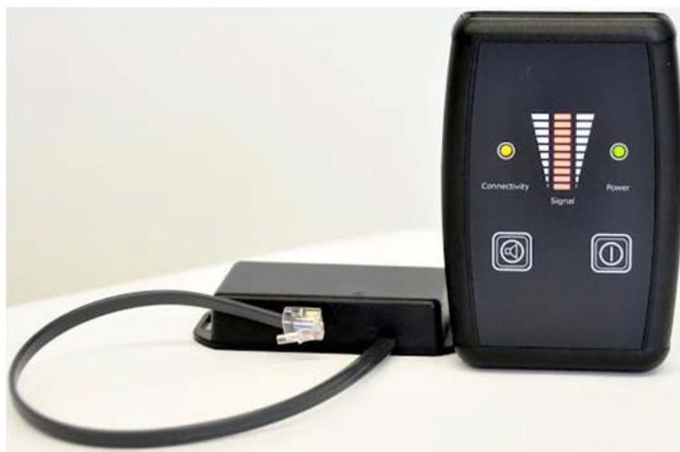
IT 44/M2 включает в себя передатчик, подключаемый к тестовому разъему извещателя (RS-485), и работающий от батареи приемник.
