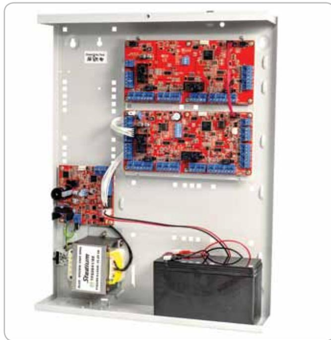
ILAM в корпусе серии M 995201PEI с установленной UniBus-картой на 2 двери/2 считывателя
