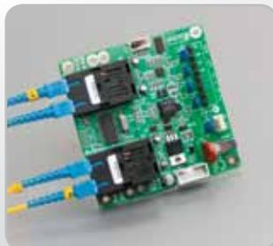
Примечание: Одномодовый оптоволоконный модем (995087) поставляется в таком же пластиковом корпусе как и Мультимодовый оптоволоконный модем. (995081) Также имеется возможность для установки печатной платы оптоволоконного модема в низкопрофильный корпус вместе с Контрольным модулем и Модулем расширения.
