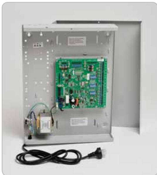
Универсальный модуль расширения обеспечивает подключение дополнительных 16 зон, 8 свободно программируемых выходов и 2 выхода для сирен, наращивается до 32 входов зон и 32 выходов.
