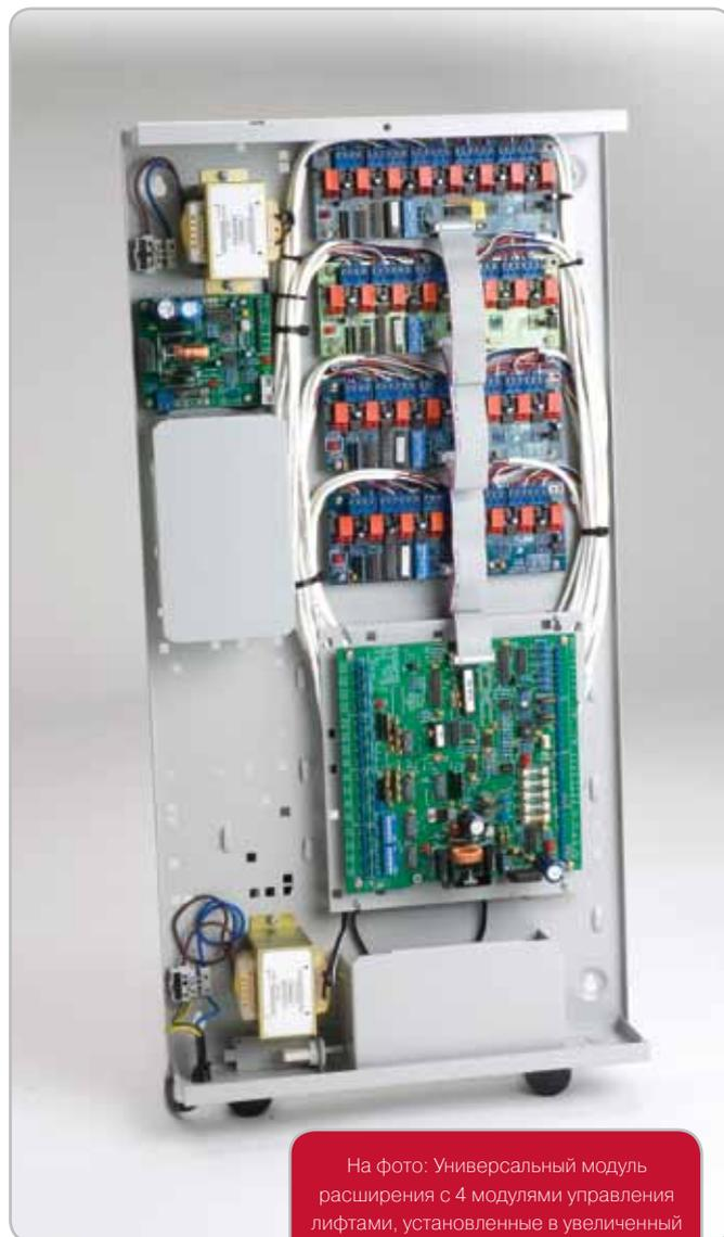
На фото: Универсальный модуль расширения с 4 модулями управления лифтами, установленные в увеличенный низкопрофильный корпус с блоком питания. В данной конфигурации реализован контроль до 32 этажей.
