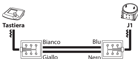
Fig. 06 Modalità di comunicazione RS-485, distanza max 1200m.
