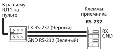
Fig. 16 Интерфейс RS-232, макс. расстояние 15м.
